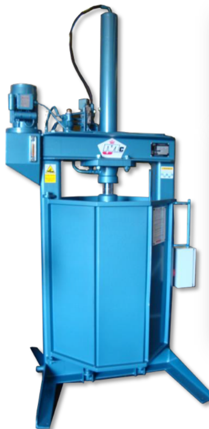
❷ DRUM-25 est équipé d'une centrale hydraulique intégrée
