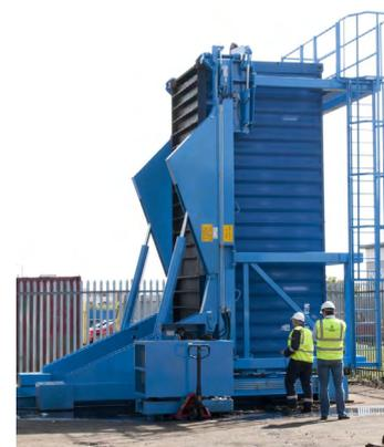
Il est pratiquement impossible de remplir un conteneur avec des matériaux en vrac lorsqu'il est dans une position horizontale. Cet équipement a été développé pour optimiser l'utilisation du volume de chargement d'un conteneur.
