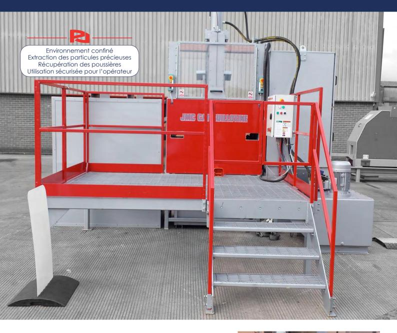
Le **CAT-GUILLOTINE** a été conçu pour offrir un environnement de travail sécurisé, confiné et efficace pour le traitement des pots et convertisseurs catalytiques. Conçu pour maximiser la sécurité et optimiser les performances, le système **CAT-GUILLOTINE** est spécialement conçu pour récupérer les particules et matières précieuses des pots catalytiques, avec aspiration des poussières.
