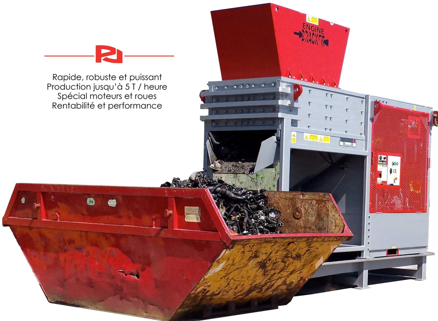
Le **CRACKER** est une machine compacte et ultra-puissante, capable de démolir et recycler les moteurs des véhicules hors d'usage.
