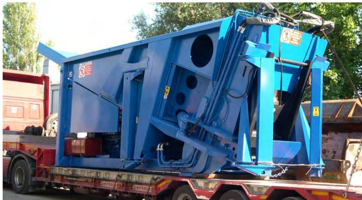
Un double vérin tandem de 3000 tonnes permet de couper simultanément jusqu'à 2 HEA de 800mm, par exemple.
