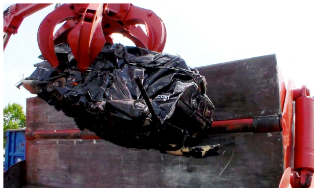
Chargement, mise en balle, déchargement en env. 4 min.
