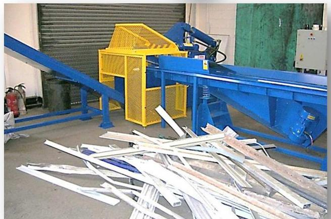
Ensemble automatisé permettant de réduire des longueurs diverses avec une production allant jusqu'à 3 tonnes/heure.
